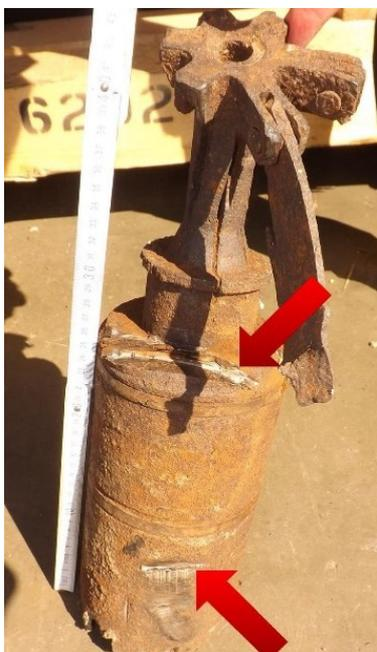
Mechanische Verformungen und Brüche wurden am Rotor, der Rotorlagerung, der Klappe, dem Einzugsband und dem Antriebszahnriemen festgestellt.
